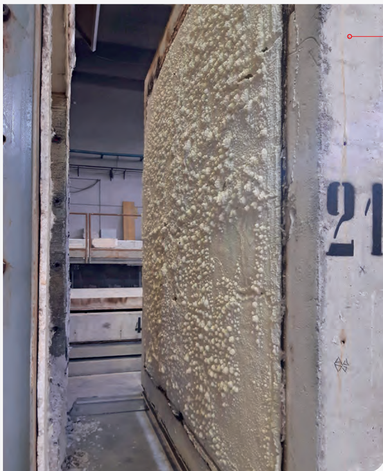
Test su parete in laterizio dopo la prova
