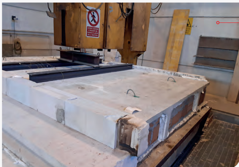
Test su tegolo TT – intradosso dopo la prova
