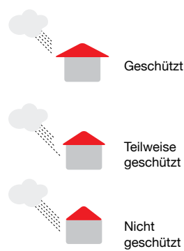
Beanspruchung des Holzes durch Klimabedingungen und Lage der Bauteile.
