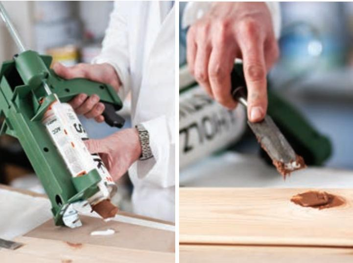
Holzstuk es una pasta bicomponente a base de resinas poliéster insaturadas. Se puede utilizar para diversos tipos de intervención, por ejemplo, reconstrucción de partes que falten, incluso de gran tamaño, estucados, acabados, etc. Es posible obtener cualquier grosor final aplicando más capas con un intervalo de pocos minutos.
