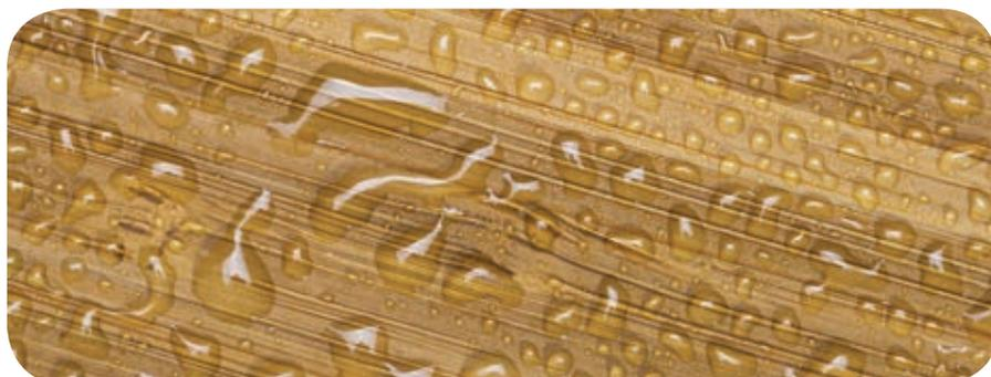
Una superficie tratada con Lignex UV Filter no absorbe el agua: las gotitas que se forman en el film de barniz indican que la protección es eficaz.
