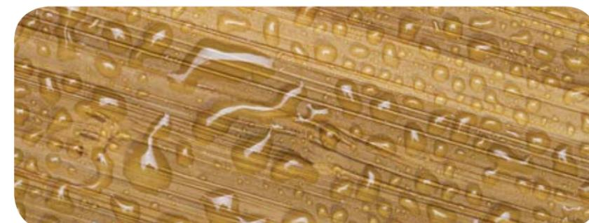
Una superficie trattata con Lignex UV Filter non assorbe l'acqua: le goccioline che si formano sul film di vernice indicano che la protezione è efficace.
